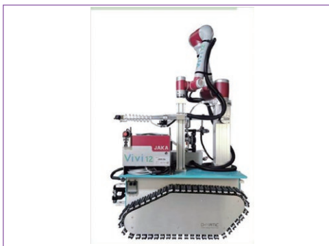
Internal Wall Painting Robot 室內牆面髹油機器人
